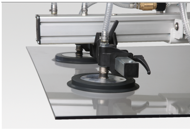
Piastre aspirazione SGF per la movimentazione di lastre di vetro delicate
